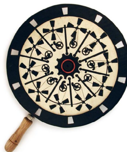
Phenakisztozkóp. 1850 körül (Tükör elé állva, arcunk elé emelve a szerkezetet, a megforgatott tárcsán lévő ábrák a réseken át nézve mozgás-illúziót keltenek.)
